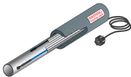
Asennettuna vesiputken ulkopuolelle
