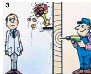
4 Troksnis, kas izplatās pa konstrukciju
